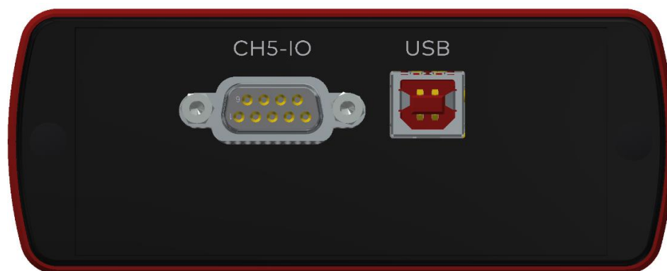
図 40: D-SUB9コネクタおよびUSBを備えたVN1640A
