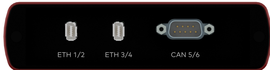
図 38: Ethernet側のコネクタ
