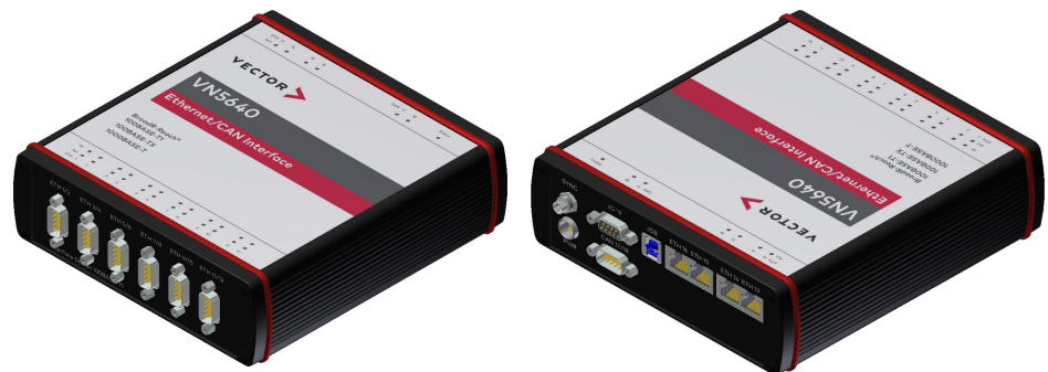
図 47: VN5640 Ethernet/CANインターフェイス
