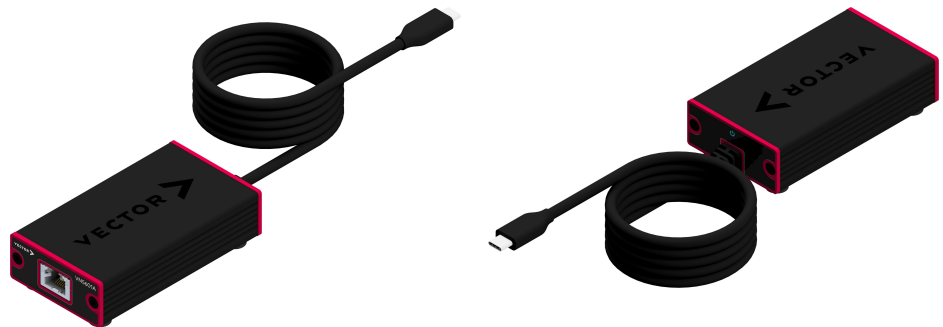
図 12: VN5601A Ethernetインターフェイス
